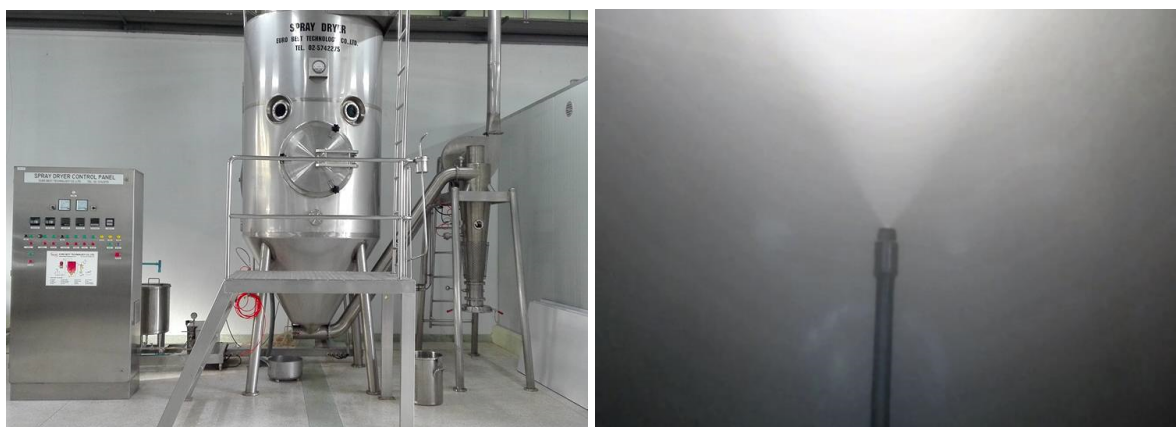
ภาพที่ 2-10 กระบวนการทำแห้งด้วยวิธีกักเก็บด้วยเครื่องระเหยน้ำแบบพ่นฝอย
